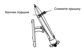
9. Добавьте несколько капель масла в отверстие для заливки и вставьте шприц, следя, чтобы в него не попали пузырьки воздуха. Если Вы видите пузырьки воздуха, закрепите шприц заново или выпустите пузырек в цилиндр и подождите, пока он не поднимется наверх, прежде чем продолжить.
