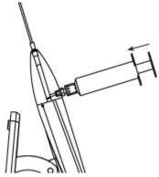
10. Теперь медленно нажимайте на поршень шприца, чтобы заполнить цилиндр и трубку. В конце заполните заливное отверстие и снова закройте его крышкой.
