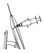
3. Медленно нажимайте на поршень шприца, пока мениск масла в цилиндре не поднимется непосредственно под наконечник. Внимательно осмотрите цилиндр — в масле не должно быть пузырьков воздуха. Если пузырьки есть, их можно удалить с помощью короткого, резкого движения заполняющего шприца, позволив им подняться к поверхности масла.
