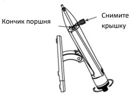
2. Заполните имеющийся в комплекте шприц маслом, открутите крышку заливного отверстия и прикрутите к нему шприц.
